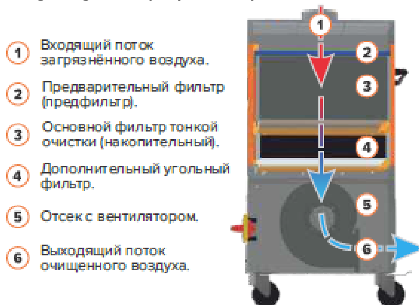
Рис. 2 Схема работы ФМ У-П(С)-1,1 (1,5) /220 (380)
