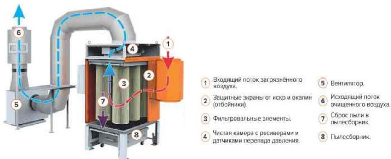
Рис. 2 Схема работы FCS-ECO-T-06
